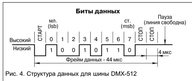
Рис. 4. Структура данных для шины DMX-512
