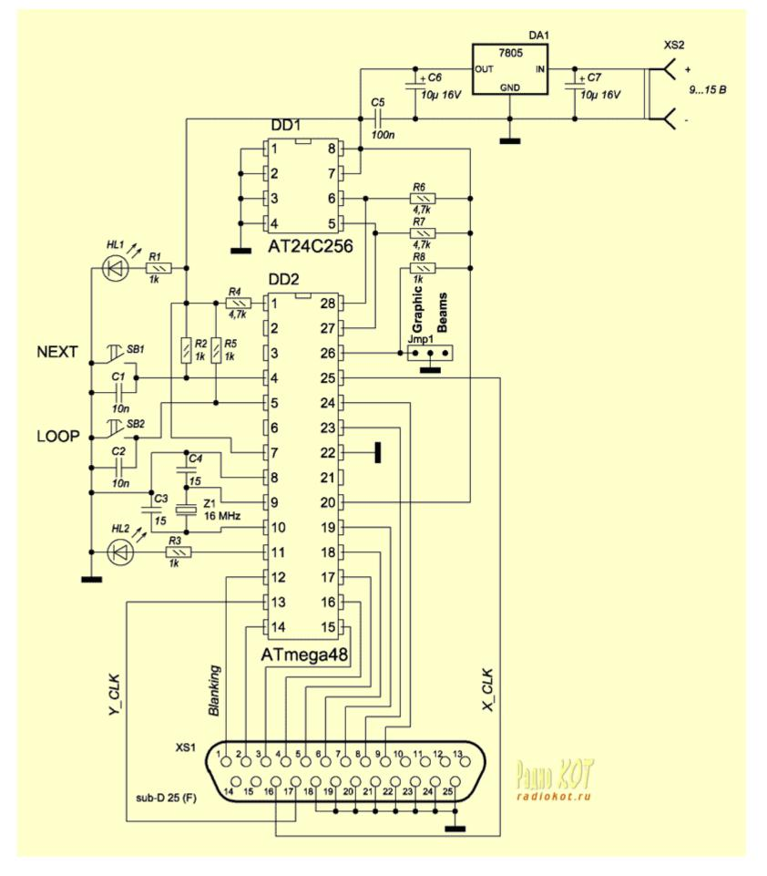
Основой схемы является МК ATmega48 [1]. Его программа в зависимости от выбранного режима работы генерирует эффекты или считывает графику из микросхемы DD1 EEPROM AT24C256 [2]. Готовые цифровые данные для ЦАП поступают на выход разъема XS1. Воспроизведение анимаций или эффектов происходит циклически, т.е. дойдя до конца программы контроллер начинает воспроизведение с начала.
