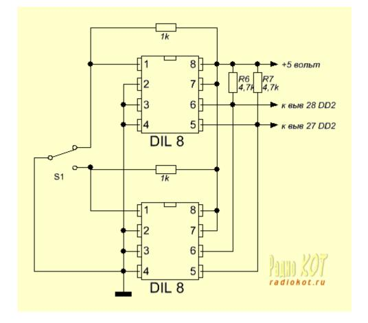
Переключателем S1 производится выбор микросхемы памяти. Аналогичным образом можно еще больше нарастить число микросхем. Выбирать микросхему следует до включения устройства.
