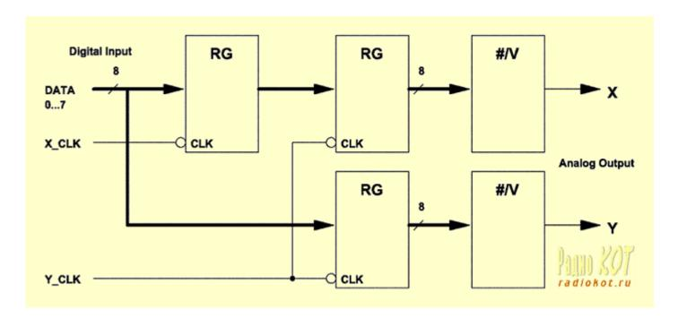
ЦАП содержит буферную память на одну точку, состоящую из трех регистров. Регистры включены так, что на выходе формируется два восьмиразрядных слова, поступающих на две независимых микросхемы ЦАП. На выходе ЦАП присутствует преобразованное в аналоговый вид значение координат точки. Линии X\_CLK и Y\_CLK являются стробирующими. При переходе напряжения с высокого логического уровня на низкий на одной из этих линий осуществляется запись в соответствующие регистры.
