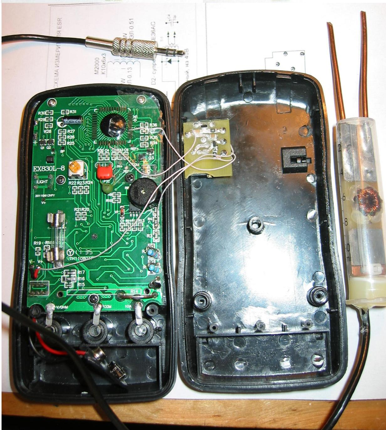
Немного изменил конструкцию - проводов меньше и с креплением платы проще - с торца припаяна платка 20x20мм, немного под наклоном, чтобы можно было надеть крышку. трансформатор разместил на пинцете. Желающим повторить - всё во вложении. Особое внимание - трансформатор, я сделал точно по рекомендациям автора, кольцо взял от энегосберегайки, с другими параметрами не шло. Всё заработало сразу, даже не настраивал (на фото - резистор 1 Ом).
